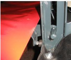
Die Kehrplane wird durch leichtes kippen mit den Aufnahmebolzen in die Aufnahmepunkte der Kehrmaschine eingeführt.
